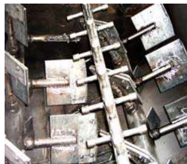
Slika 8. Horizontalna mješalica, rotor sa spiralom i rotor s prigradenim lopaticama
