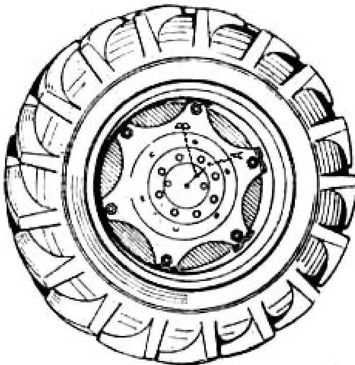
sl. 17. Pravilan položaj otvora A i B na zadnjem točku
