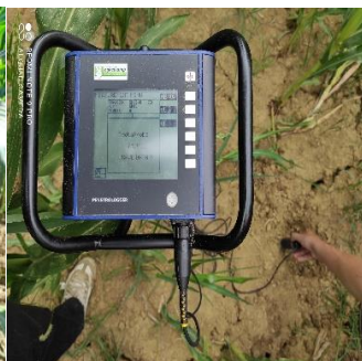
Slika 10. Mjerenje vlage tla
