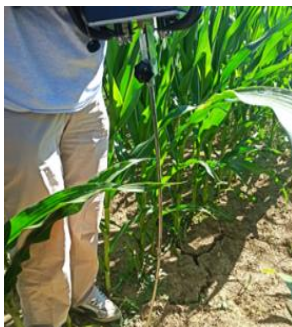
Slika 9. Mjerenje mehaničkog otpora tla
