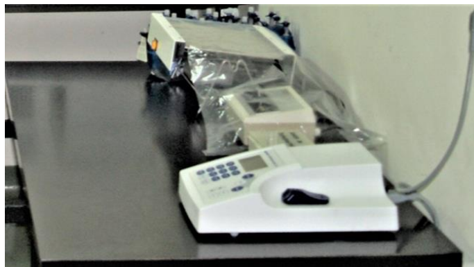
Slika 170: Određivanje koncentracije i čistoće DNA biofotometrom plus (eppendorf)
