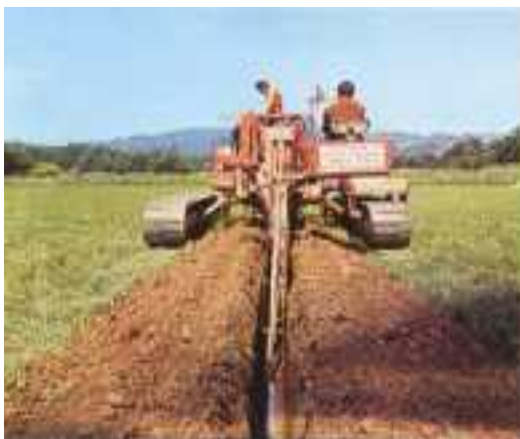
Slika 36. Drenopolagač - radni dio stroja u obliku frese
